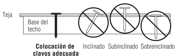
Figura 1-3: Colocación de clavos correcta e incorrecta
